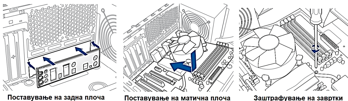
Слика 2.28. Чекори при монтажа на матична плоча
