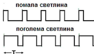
Слика 4.22. Зависност на интензитетот на светлина од ширината на импулсите
