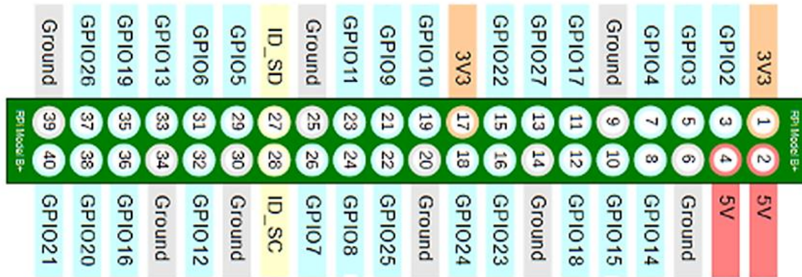
Слика 4.15. Означување и функционален опис на GPIO пиновите
