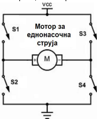
Слика 4.24. Принцип на работа на H-мост
